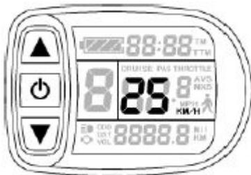
Après avoir allumé la console et avant 5 secondes, appuyez en même temps sur les touches ▲ et ▼, la vitesse d'entraînement maximale (en km/h) clignote. Appuyez brièvement sur ▲ ou ▼ pour modifier la vitesse d'entraînement maximale (par défaut 25 km/h). Appuyez brièvement sur le bouton ⏻ pour passer aux paramètres suivants.
