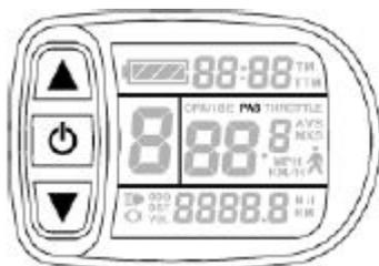
Témoin d'assistance au pédalage: dès que le capteur de pédalage détecte le pédalage, le témoin s'allume. L'assistance moteur est alors mise en route.
