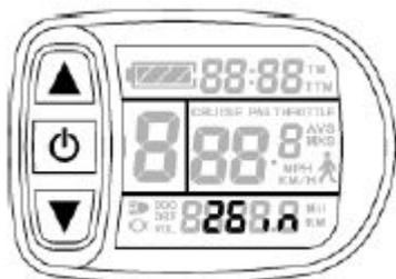
Le diamètre de la roue s'affiche après le réglage de la vitesse d'entraînement maximale. Appuyez brièvement sur ▲ ou ▼ pour modifier le diamètre de la roue. Sélectionnez parmi 8, 10, 12, 14, 16, 18, 20, 22, 24, 26, 700c ou 28 pouces. Appuyez brièvement sur le bouton ⏻ pour passer aux paramètres suivants.
